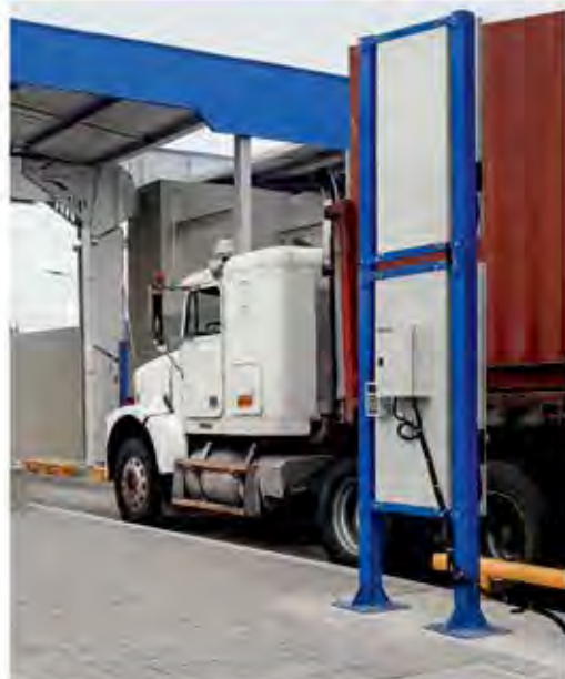
На фото - портальный радиационный монитор
